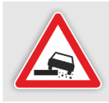
A8 accotement non stabilisé
